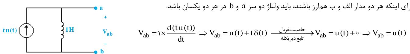
$$V_{ab} = 1 \times \frac{d(tu(t))}{dt} \Rightarrow V_{ab} = u(t) + t\delta(t) \xrightarrow{\substack{\text{خاصیت غربال} \\ \text{تابع دیریکله}}} V_{ab} = u(t) + 0 \Rightarrow V_{ab} = u(t)$$
