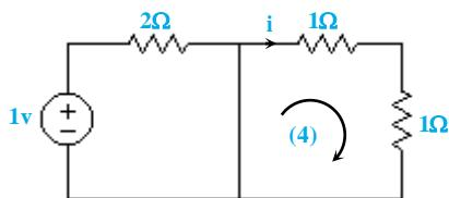
در  $t = \infty$  ، خازن مدار باز و سلف اتصال کوتاه می‌شود و داریم:
