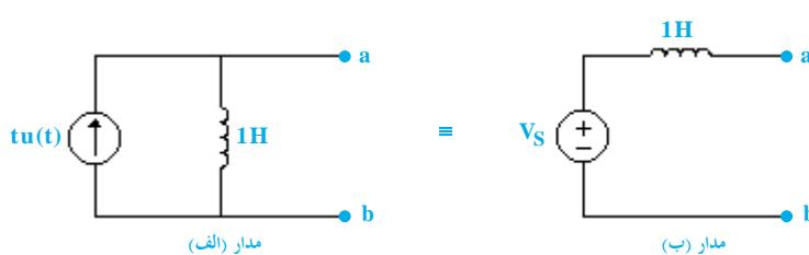
برای اینکه هر دو مدار a و b هم‌ارز باشند، باید ولتاژ دو سر a و b در هر دو یکسان باشد.
