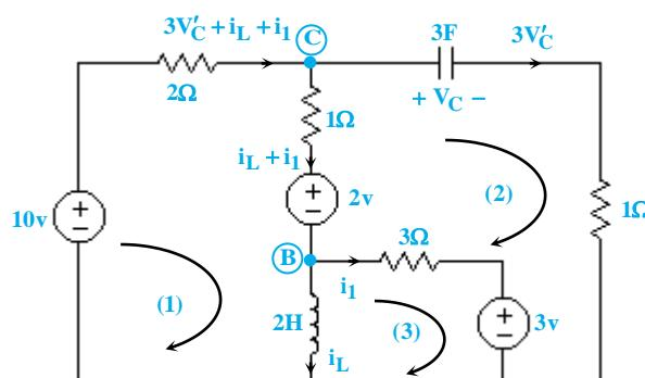
$$KCL_B : 2V = i_L + i_1 \quad \text{جریان مقاومت } 2\Omega \text{ اسرا} \text{ با منبع ولتاژ}$$
