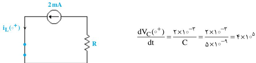
برای زمان‌های مثبت مدار به صورت RLC سری می‌باشد. بنابراین معادله دیفرانسیل ولتاژ خازن به صورت زیر می‌باشد:
