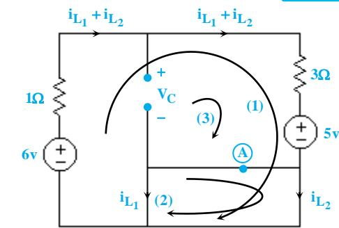
۳۵- گزینه «۲» ابتدا مدار را برای  $t = 0^-$  که به حالت دائمی رسیده است تحلیل می‌کنیم. در این زمان، خازن مدار باز و سلفها اتصال کوتاه هستند. با در نظر گرفتن رابطه KCL برای گره A، جریان مقاومت  $3\Omega$  در جهت مشخص شده بر روی شکل برابر  $i_{L1} + i_{L2}$  می‌گردد. با توجه به این که خازن مدار باز می‌باشد، جریان مقاومت  $1\Omega$  نیز برابر  $i_{L1} + i_{L2}$  خواهد شد.
