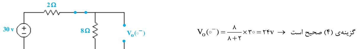
$$V_0(o^-) = \frac{\lambda}{\lambda+2} \times 30 = 24V \rightarrow \text{گزینه} (4) \text{ صحیح است}$$
