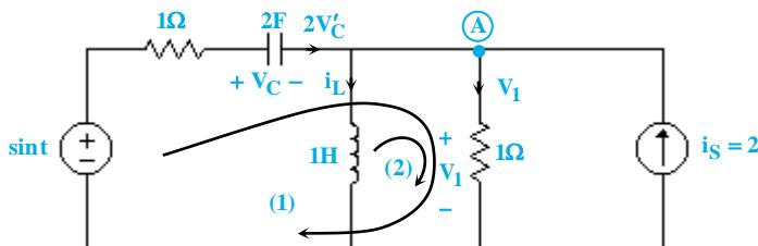
باتوجه به این که ولتاژ مقاومت  $1\Omega$  برابر  $V_1$  است، جریان این مقاومت در جهت مشخص شده برابر  $V_1$  می‌شود.
