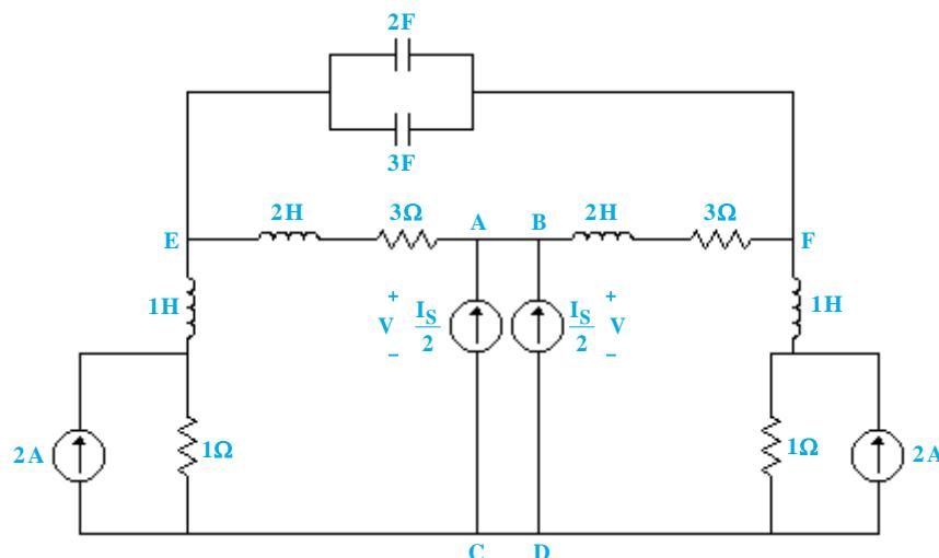
با توجه به تقارن مدار، جریان در شاخه‌های  $\underline{EF}$ ,  $\underline{CD}$ ,  $\underline{AB}$  و  $\underline{EF}$  صفر می‌شود. بنابراین کافی است که مدار روبرو را حل کنیم.
