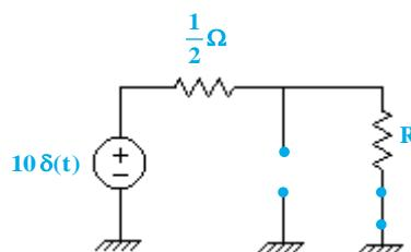
۶- گزینه «۳» برای تحلیل مدار به ازای ورودی  $\delta(t)$ ، خازن اتصال کوتاه و سلف مدار باز در
