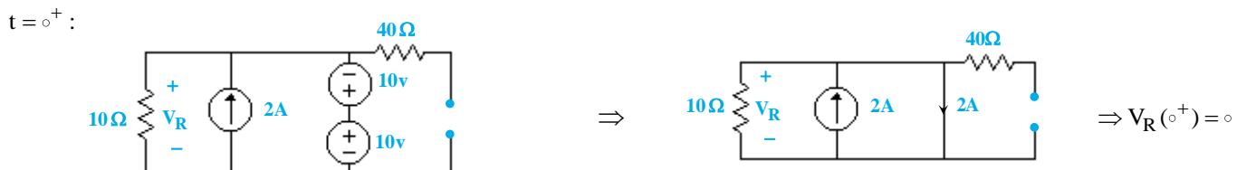
۳۱- گزینه «۳» ابتدا مدار را برای  $t < \circ^-$  که به حالت دائمی خود رسیده است، تحلیل می‌کنیم. در این حالت، هر دو کلید باز هستند و سلف اتصال کوتاه و خازن مدار باز است.
