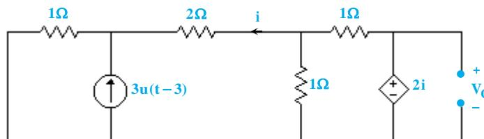
دقیق کنید که در حالت دائمی، با توجه به این که تمامی منابع DC هستند، سلف اتصال کوتاه و خازن مدار باز می‌شود و داریم:
