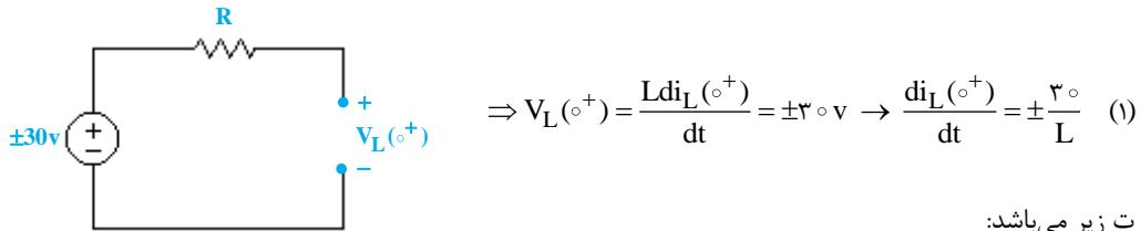
از طرفی معادله مشخصه مدار به صورت زیر می‌باشد:
