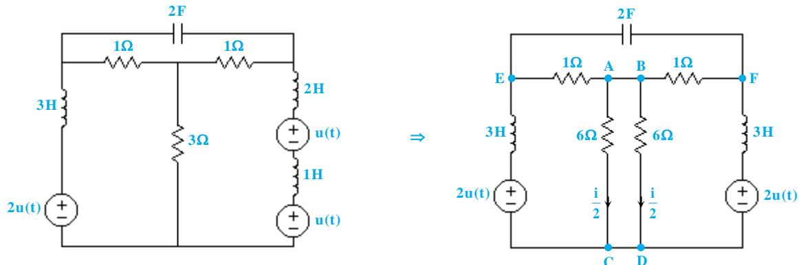
دقیق برای اینکه مدار متقاضی باشد، مقاومت  $2\Omega$  را به صورت  $\frac{1}{2}$  مقاومت  $3\Omega$  قرار دادیم که از هر کدام می‌گذرد که در مجموع همان جریان  $i$  از مقاومت  $2\Omega$  خواهد گذشت. با توجه به تقاضن شکل، جریان شاخه‌های EF، CD، AB و EF صفر می‌باشد. بنابراین مدار روبه‌رو را خواهیم داشت:
