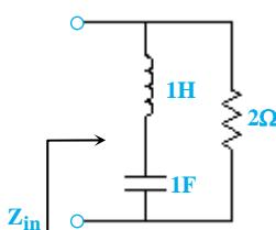
مقدار  $Z_{in}$  در مدار شکل زیر کدام است؟
