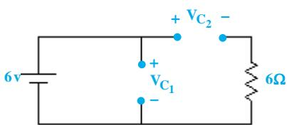
$$V_{c_1}(\circ^-) = V_{c_2}(\circ^-) = 6V$$
