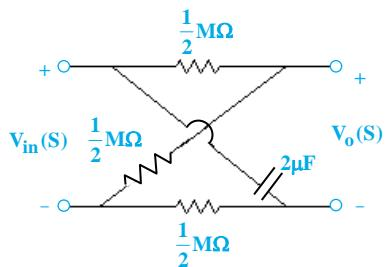
**۸** در مدار زیر تابع انتقال  $\frac{V_o(S)}{V_{in}(S)}$  کدام است؟
