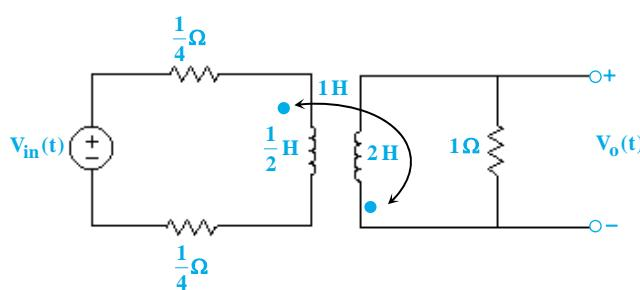
۱۶- در مدار زیر تابع انتقال  $\frac{V_o(S)}{V_{in}(S)}$  کدام است؟
