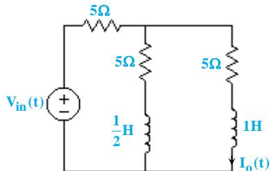
۱۵- تابع انتقال  $\frac{I_o(S)}{V_{in}(S)}$  در مدار زیر کدام است؟
