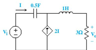
تابع تبدیل  $H(S) = \frac{V_o(S)}{V_i(S)}$  برای مدار شکل زیر کدام است؟
